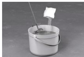
3. Katalysator (laut Mischtafel, Temperatur- und Verarbeitungszeit) bei langsam laufendem Rührwerk zugeben und mind. 2 Min. (bitte die jeweilige Produktinformation in diesem Handbuch beachten!) mischen. (Kleinmengen können auch von Hand gemischt werden)
