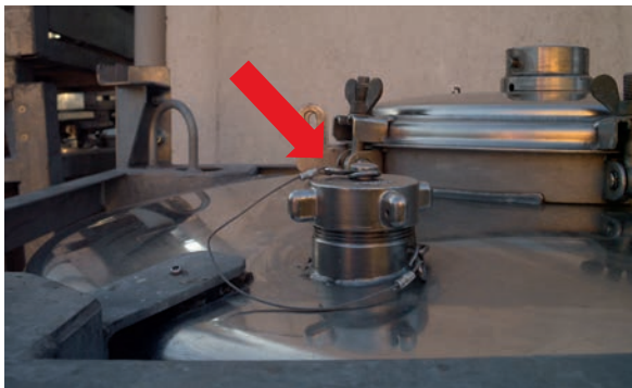
VARIANTE 2: Entlüftungsventil Edelstahl-Container
